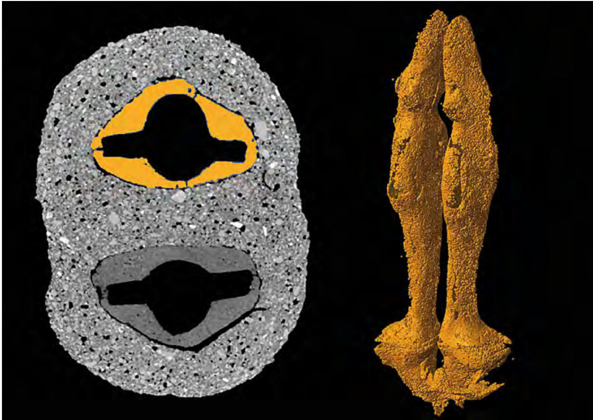
Abb. 7.15: Gussform QH 207/45 (Kat. 4.8), Links Schnittfläche, rechts Segmentierung und Freistellung der inneren ersten Tonschicht. Diese umgab die beiden Wachsmodelle der Osirisfiguren, welche nach dem Ausschmelzen und Brennen der Form einen Hohlraum erzeugte, in den die Bronze eingegossen werden sollte (Abb.: D. Meinel).
